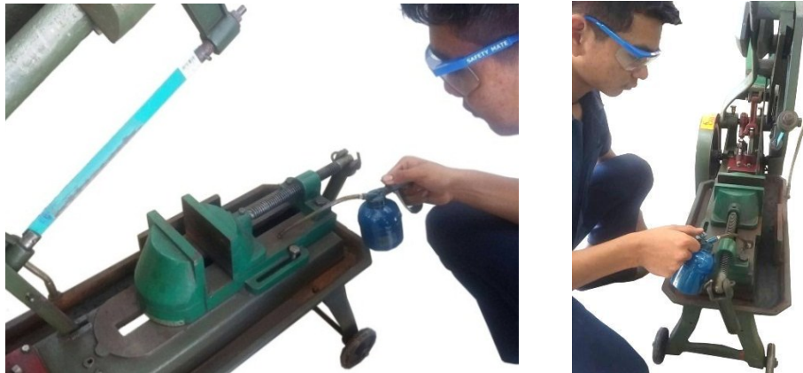
รูปที่ 7. การชโลมน้ำมันที่ผิวของส่วนประกอบเครื่องเลื่อยกลชัก
