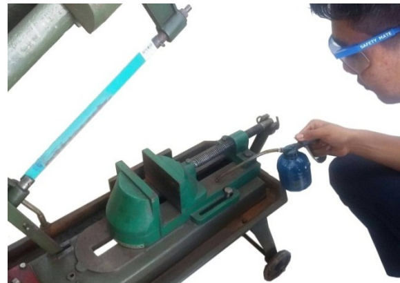
(ข) การหยอดน้ำมันที่ชิ้นส่วนของเครื่องเลื่อยกล
