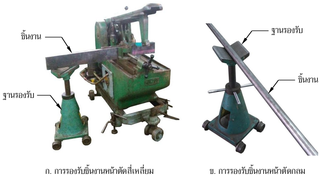
รูปที่ 1.15 การใช้ฐานรองรับชิ้นงานขณะตัดชิ้นงาน
