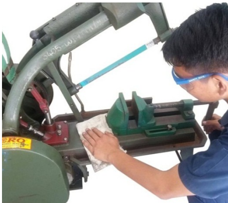
(ก) การทำความสะอาดด้วยผ้า
