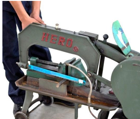
รูปที่ 5. การปรับใบเลื่อยลงหาชิ้นงาน
