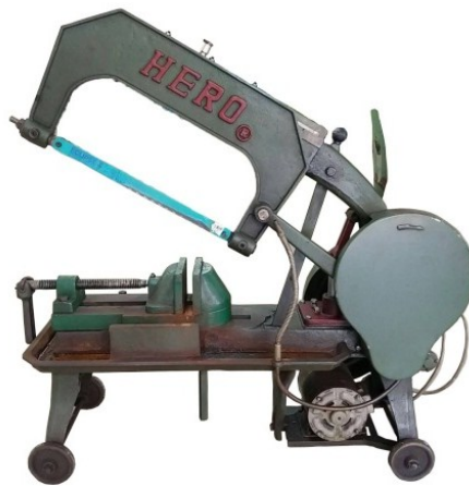
รูปที่ 1.2 เครื่องเลื่อยกลชักชนิดป้อนตัดด้วยไฮดรอลิก (ที่มา: คงศักดิ์ ตันทรวาวัฒน์พันธ์, 2562)
