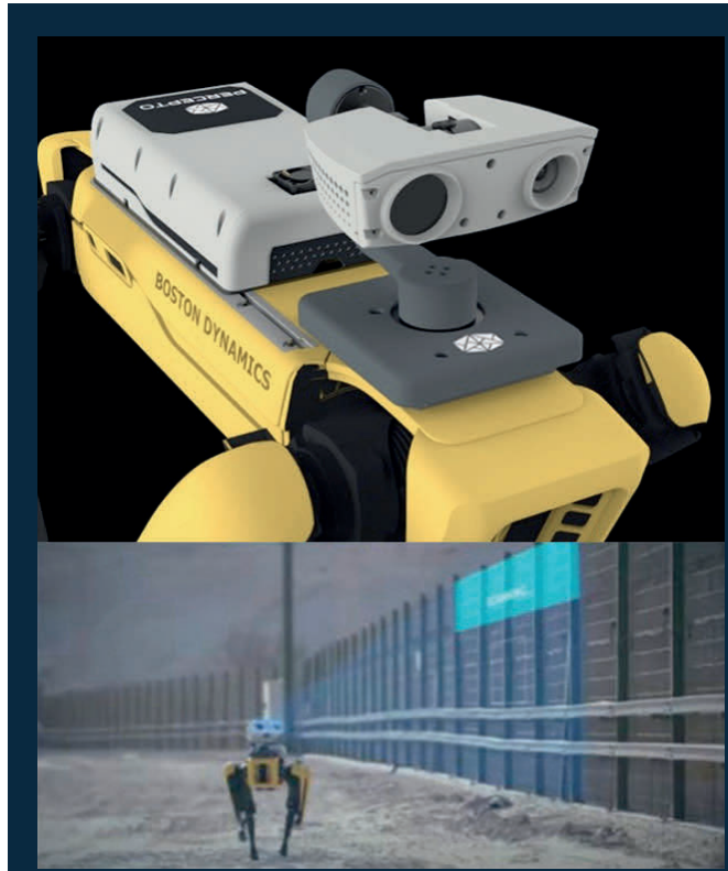
รูปที่ 10 (บน) แสดงเซนเซอร์และกล้องความละเอียดสูงที่แสดงภาพความร้อนได้ ซึ่งติดตั้งบริเวณส่วนหัวของหุ่นยนต์สป็อตและโปรแกรมควบคุมที่ติดตั้งอยู่บนหลังของหุ่นยนต์สป็อต (ล่าง) หุ่นยนต์สป็อต Spot ขณะตรวจโรงงานแห่ง ICL Dead Sea ภาพจาก https://www.youtube.com/watch?v=ESW8do5NLr0
