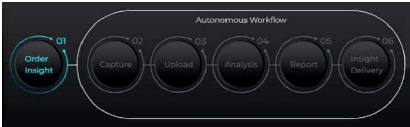
รูปที่ 5 แสดงขั้นตอนการตรวจโรงแต่งแร่ของ Percepto AIM ที่มีเพียงขั้นตอนแรกกับมนุษย์สั่งการ หลังจากนั้นระบบจะทำการตรวจสอบ วิเคราะห์และแสดงผลอัตโนมัติทั้งหมด ภาพจาก https://percepto.co/aim
