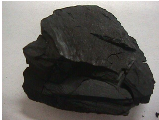
ภาพที่ 2.11 แสดงถ่านหินประเภทซับบิทูมินัส
