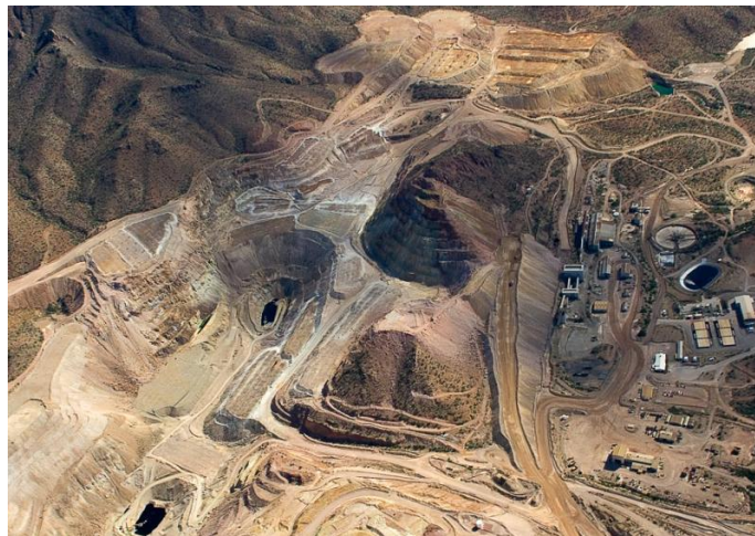
ภาพที่ 2.14 แสดงการทำเหมืองถ่านหินแบบเปิด
