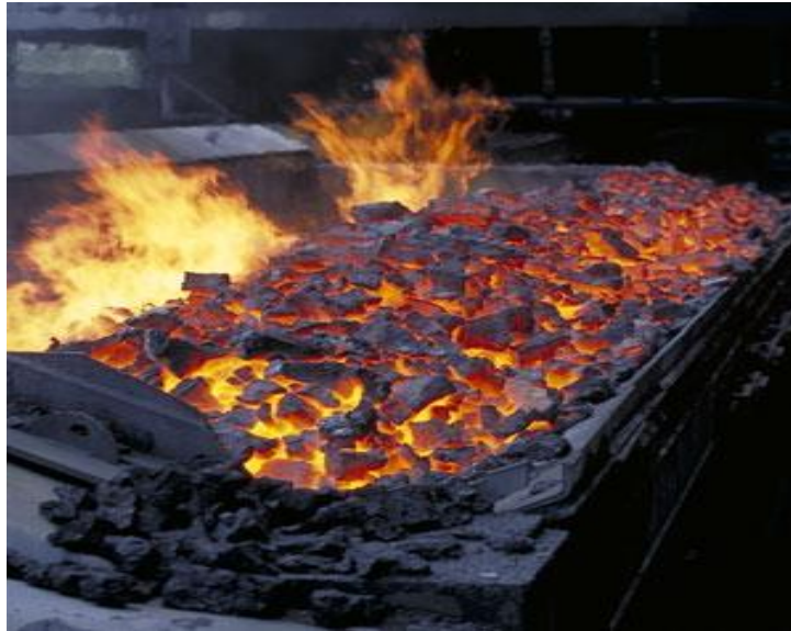
ภาพที่ 2.19 แสดงถ่านโค้กวัตถุดิบในการถลุงเหล็ก (ที่มา : http://www.steel.pk )
