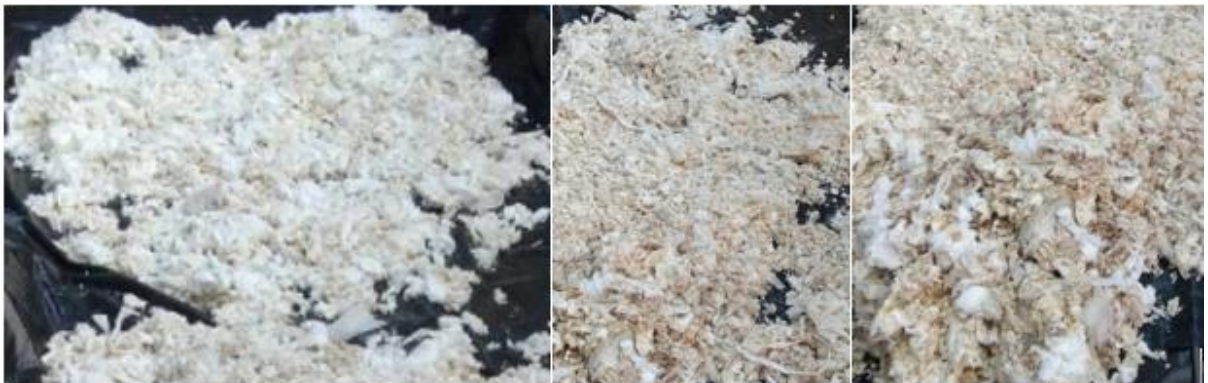
ภาพที่ 2.5 สารโพลีเมอร์และ cellulose pulp ที่ถูกแยกออกจากพลาสติกห่อหุ้มชั้นนอก
