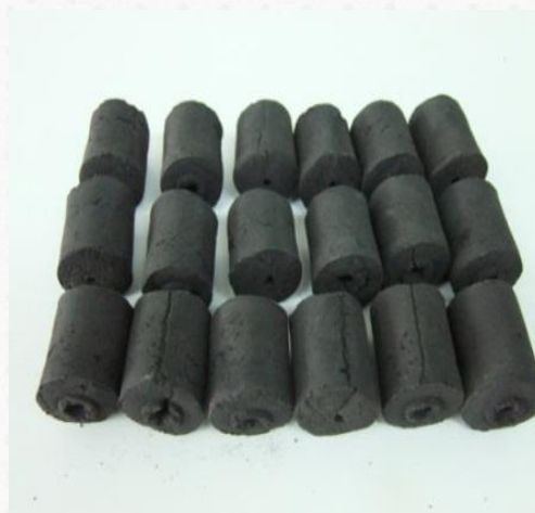
รูปที่ 5 เผาเป็นถ่านผสมกาวแปงเปียกอัดเป็นแท่ง
