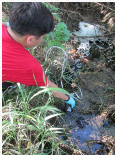
ภาพที่ 4 การเก็บตัวอย่างน้ำชะขยะหลังบำบัดที่ปล่อยลงสู่แหล่งน้ำสาธารณะ
