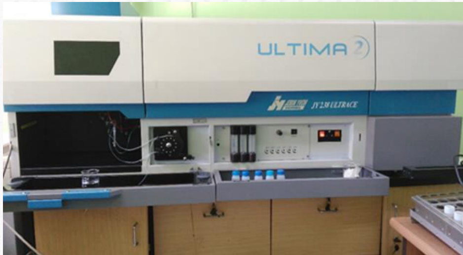
ภาพที่ 5 เครื่อง Inductive coupled plasma optical emission spectrometer (ICP-OES)
