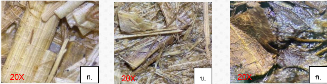
ภาพ 2 ลักษณะเส้นใยของชีวมวล (ก. ฟางข้าว ข.ใบอ้อย ค.ใบลำไย) เมื่อศึกษาด้วยกล้องสเตอริโอที่กำลังขยาย 20 เท่า
