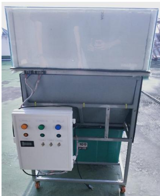
ภาพที่ 3.17 ชุดกำเนิดไฟฟ้าด้วยเทอร์โมอิเล็กทริกจากพลังงานความร้อนแสงอาทิตย์เสร็จสมบูรณ์
