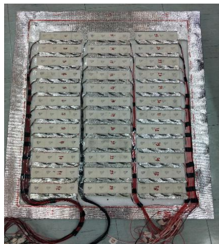
ภาพที่ 3.16 การต่อวงจรแผ่นเทอร์โมอิเล็กทริกวางในร่องฉนวน
