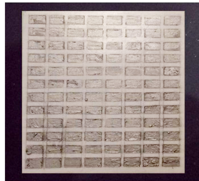
ขั้วไฟฟ้ากาวเงินบนแผ่นเซรามิกฐานรอง
