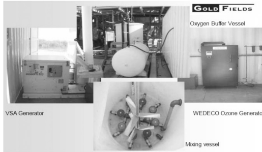
รูปที่ 28 การนำขบวนการเคมีไอโซนมาใช้งานจริงในเหมืองแร่ต่างประเทศ เพื่อแก้ไขปัญหาการตกตะกอนไซยาไนด์ และบำบัดไซยาไนด์ 22
