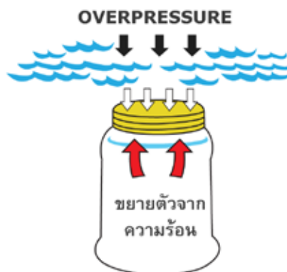
รูปที่ 3.13 ความดันเพิ่มจากปกติเพื่อให้ภาชนะบรรจุไม่เสียหายและไม่สูญเสียการปิดผนึก ที่มา: GMA Science and Education Foundation (2007)
