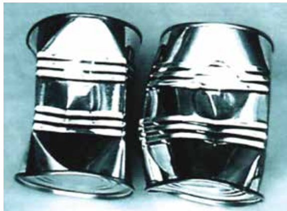
รูปที่ 4.6 การเกิด Paneling อย่างรุนแรงของผนังด้านข้างของกระป๋อง
