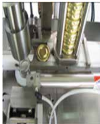
รูปที่ 14.7 การทำงานของเครื่องปิดฝาขวดแก้วที่สามารถใช้ไอน้ำสร้างสุญญากาศ
