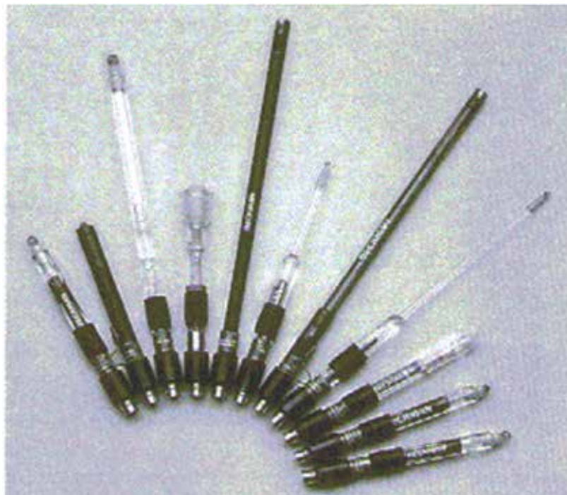
รูปที่ 7.5 รูปแบบต่างๆ ของอิเล็กโทรดแบบรวม (Combination electrodes) ที่มา: Gavin and Weddig (1995)
