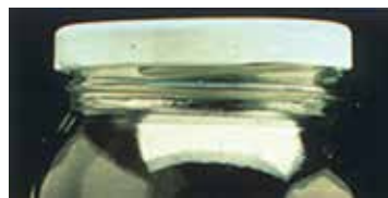
รูปที่ 14.9 ลักษณะข้อบกพร่องของฝาแบบ Cocked cap
