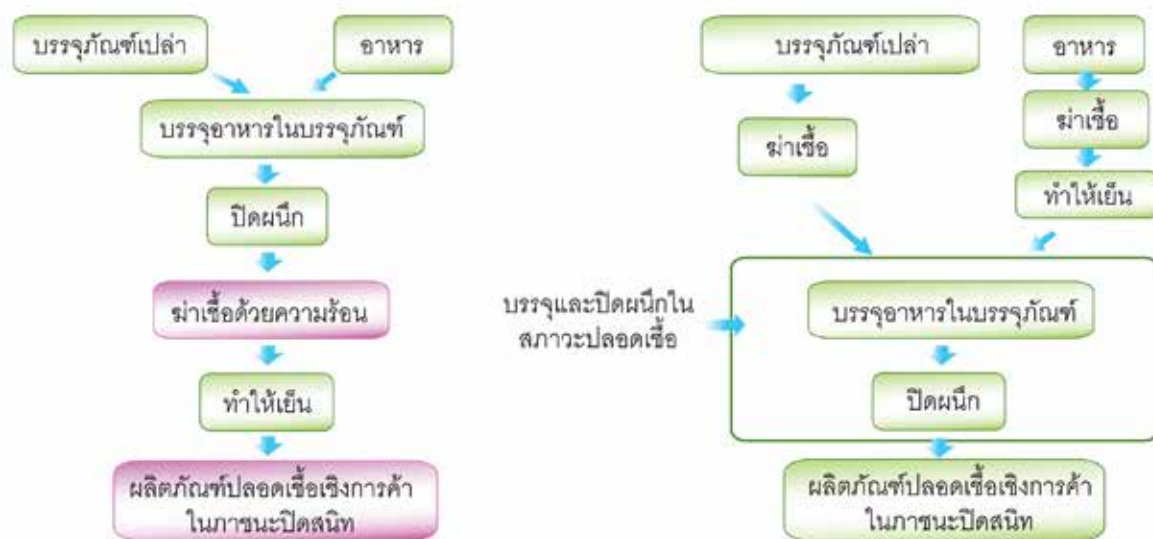
รูปที่ 3.1 การผลิตอาหารในภาชนะปิดสนิท (ซ้าย) แบบดั้งเดิม (ขวา) การผลิตและบรรจุแบบปลอดเชื้อ ที่มา: GMA Science and Education Foundation (2007)
