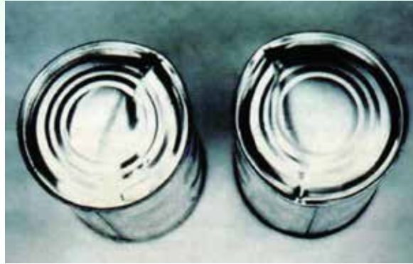
รูปที่ 4.5 การเกิด Buckling ของกระป๋อง
