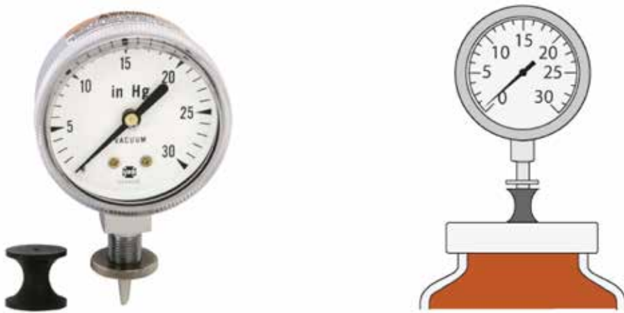
รูปที่ 4.4 Vacuum gauge สำหรับวัดสุญญากาศในภาชนะบรรจุที่ปิดสนิท
