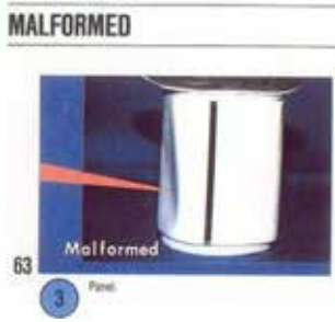
รูปที่ 13.15 ตัวอย่างข้อบกพร่องของถ้วยพลาสติกที่ปิดฝาด้วยความร้อน
