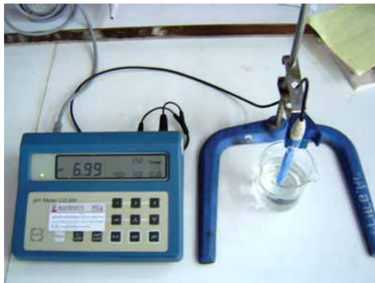
รูปที่ 7.2 เครื่องวัดความเป็นกรด-ด่างแบบดิจิทัลที่ใช้หัววัดเป็นแบบอิเล็กโทรดรวม (Combined electrode)
