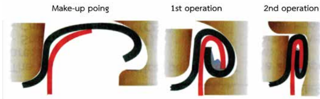
รูปที่ 12.6 ขั้นตอนการปิดผนึกตะเข็บสองชั้น
