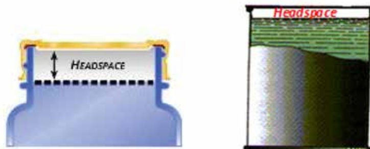
รูปที่ 4.3 ช่องว่างเหนืออาหาร (Headspace) ในขวดแก้วและในกระป๋อง
