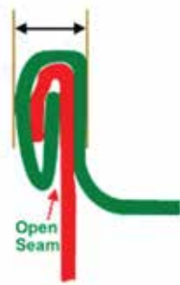
รูปที่ 12.28 Seam bump หรือ Sprung Seam
