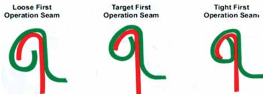
รูปที่ 12.20 Loose / Tight first operation seam
