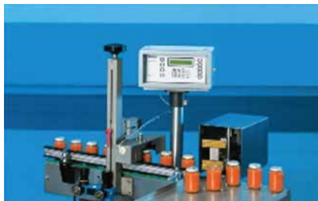
รูปที่ 14.8 การทำงานของเครื่อง Dud detector เพื่อตรวจสอบสุญญากาศภายในขวด ที่มา: http://www.silganwhitecap.com/equipment/dud-detector.html
