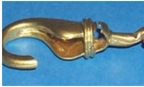
ภาพที่ 4: ลักษณะชิ้นงานที่น้ำโลหะไหลเข้าโพรงแบบไม่สมบูรณ์
