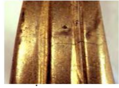
รูปพรุนเนื่องจากก๊าซเมื่อสังเกตรด้วยตาเปล่า
