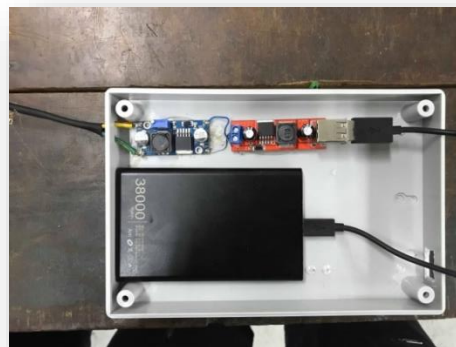
ภาพที่ 3.5.4.3 การต่อวงจรชุดแปลงไฟ และ แบตเตอรี่สำรองไฟ
