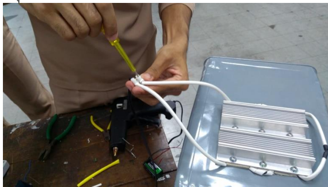
ภาพที่ 2.4 ต่อดวงจรของแผ่น Thermoelectric
