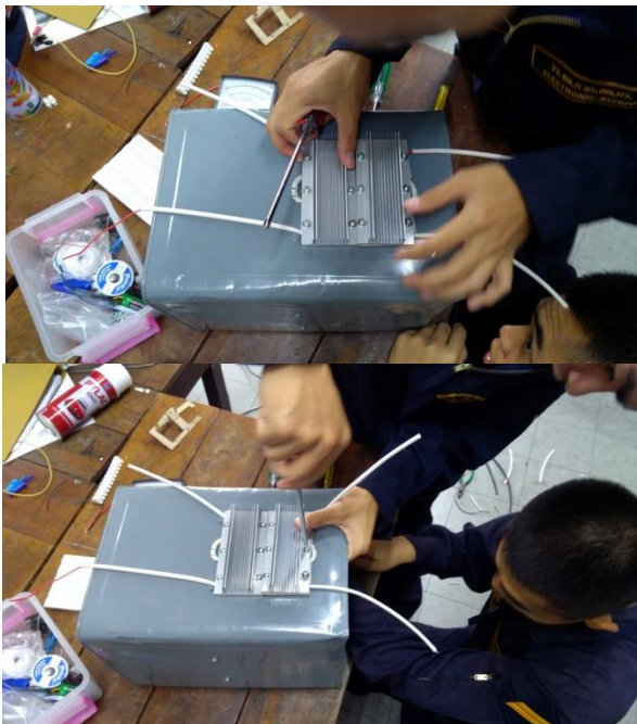
ภาพที่ 2.3 ประกอบชุดแผ่นThermoelectric กับตัวเตา
