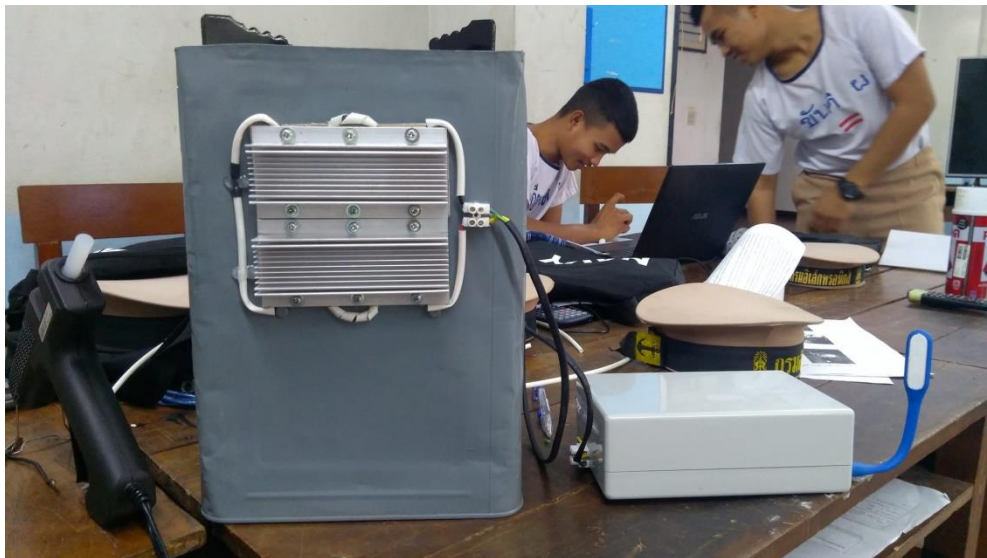
ภาพที่ 4. ตัวอย่างเครื่องผลิตไฟฟ้าจากเตาความร้อน
