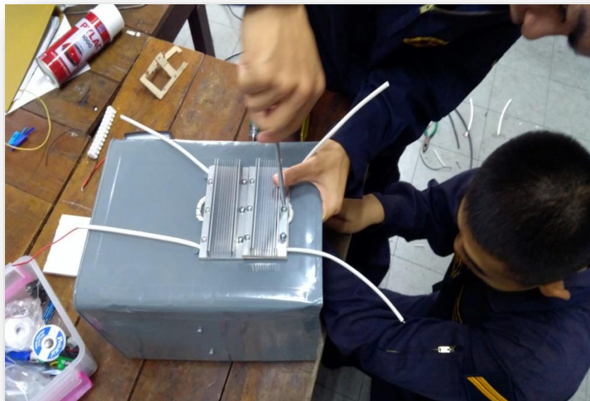
ภาพที่ 3.5.3.8 นำชุดแผ่น thermoelectric generator ติดกับปั๊ม
