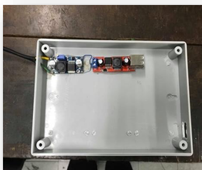
ภาพที่ 3.5.4.3 การต่อวงจรชุดแปลงไฟ และ แบตเตอรี่สำรองไฟ
