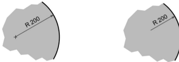
รูปที่ 3.12 การบอกขนาดส่วนโค้ง (จิรพงศ์ กสิวิทย์อำนาจ, 2550)
