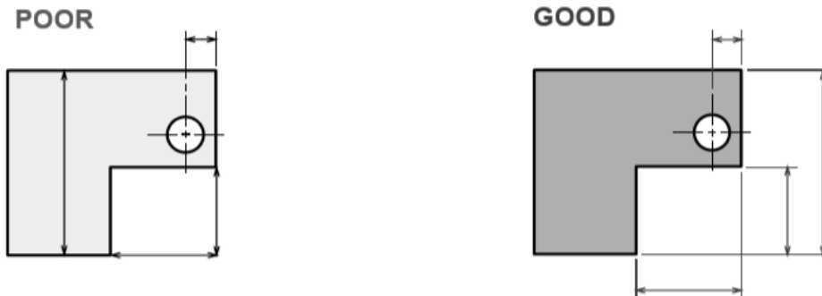
รูปที่ 3.27 ห้ามใช้เส้นรูปเส้นศูนย์กลางหรือเส้นบอกขนาดแทนเส้นกำหนดขนาด (จิรพงศ์ กสิวิทย์อำนาจ, 2550)
