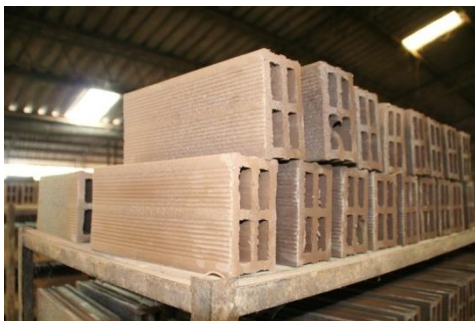
รูปที่ 1.18 ตัวอย่างการขึ้นรูปโดยใช้เครื่องอัดรีด Extrusion
