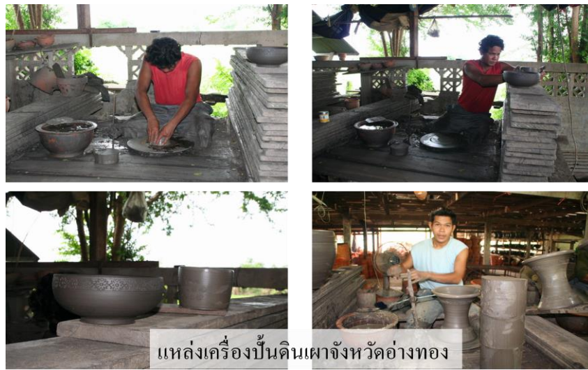
รูปที่ 1.15 ตัวอย่างการขึ้นรูปโดยใช้แป้นหมุน Throwing
