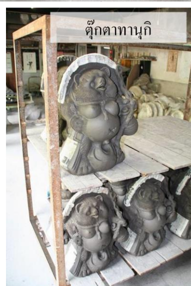
รูปที่ 1.14 ตัวอย่างการกดอัดขึ้นรูปโดยมีแม่พิมพ์ ปูนปลาสเตอร์
