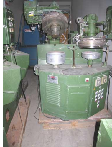
รูปที่ 1.17 ตัวอย่างการขึ้นรูปโดยใช้ Roller head
