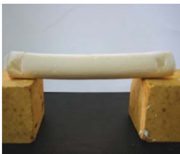
รูปภาพแสดงการทดสอบการ Warpage ของชิ้นงาน
