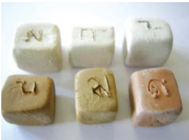
รูปภาพแสดงการทดสอบความเหนียวของดินโดยวิธี Atterberg's limits
