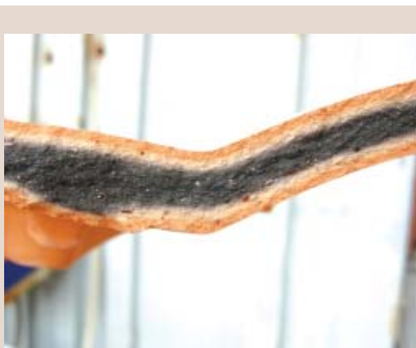
รูปภาพแสดงปัญหา Black core ในเนื้อดินแบบเผาเร็ว (Fast firing)
