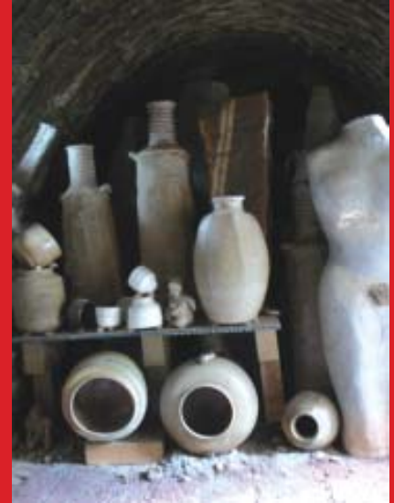
การจัดวางภายในเตาที่เราจะต้องเป็น อันหนึ่งอันเดียวกับกับเตาจากนั้นเปลวไฟ จะกำหนัดที่แต่บระบายสี
