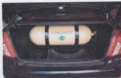
รูปการติดตั้งถัง
