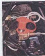
รูปอุปกรณ์รับเติมก๊าซ
