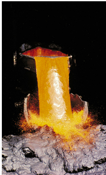
รูปที่ 10.11 ทองแดงหลอมเหลวที่ได้จากการถลุงทองแดง
