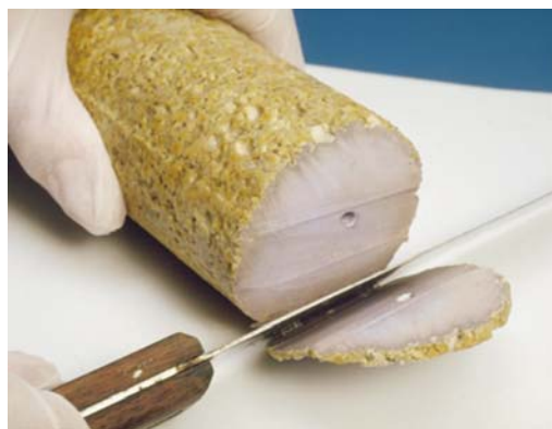
รูปที่ 10.13 สมบัติของโซเดียม อ่อนนุ่มและทำปฏิกิริยากับน้ำอย่างรุนแรง
